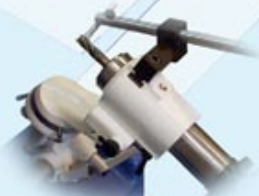
Ø30mm'ye kadar Parmak Freze Bileme Ataşmanı
